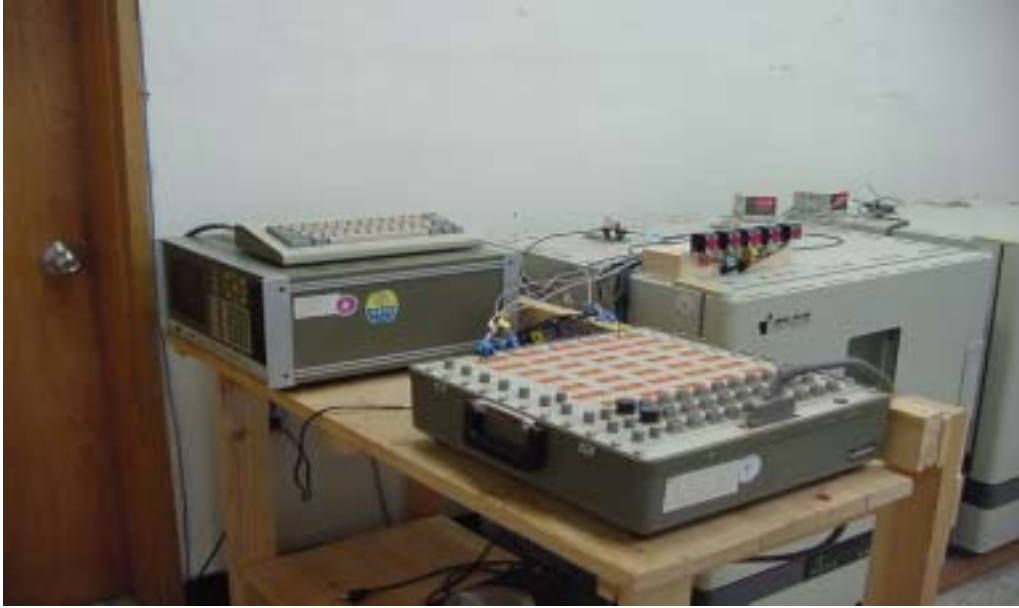
Figure 3. 2. 8. 장고 초갈이재의 송풍오-분건조시험중의 수증기압 및 온도분포 계측시스템
