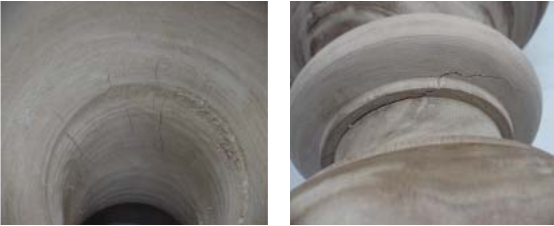
Figure 3. 2. 4. 초갈이 C-CO 처리재의 예비송풍오-분건조시험중 내피면(왼쪽)과 외피면(오른쪽)에 발생한 할렬과 윤활의 모습
