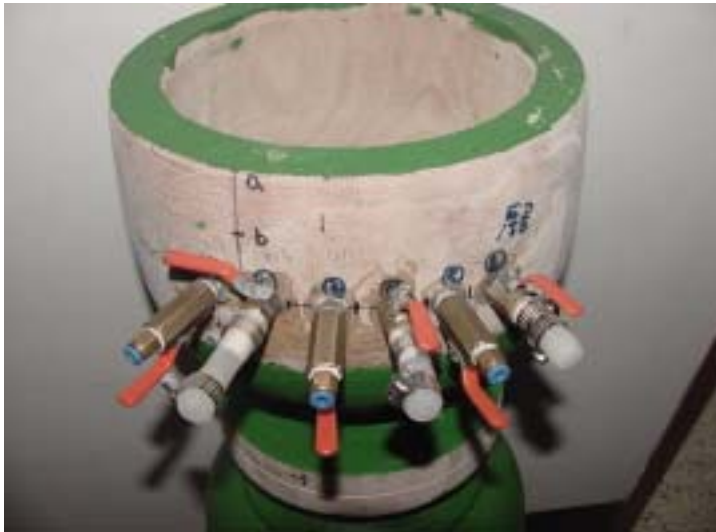
Figure 3. 2. 6. 시험편내에 압력 및 온도센서의 삽입 위치 모식도(왼쪽)와 실제 모습(오른쪽)
