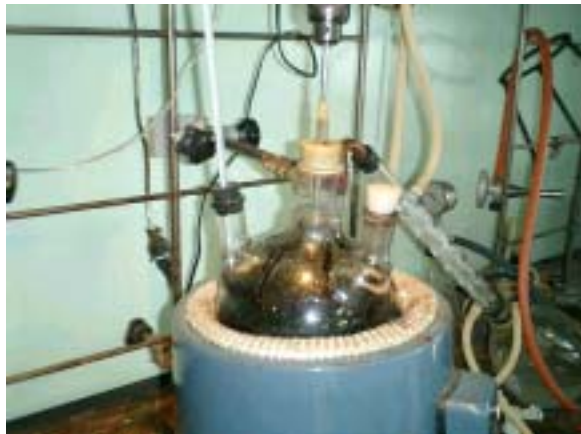
<그림 1-25> 액화목재를 이용한 노블락수지 제조
