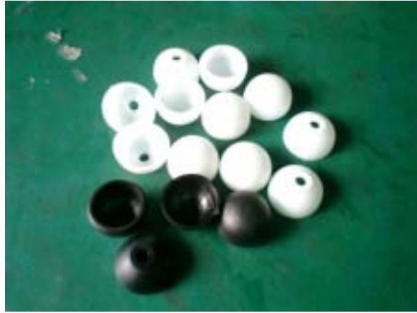
<그림 1-52> 액화목재 혼련 플라스틱 시작품(연습용 수류탄) (검은색: 액화목재 혼련 플라스틱, 흰색 : 플라스틱)
