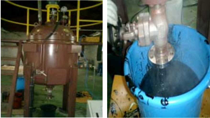
<그림 1-2> 액화목재 제조장치 및 액화물
