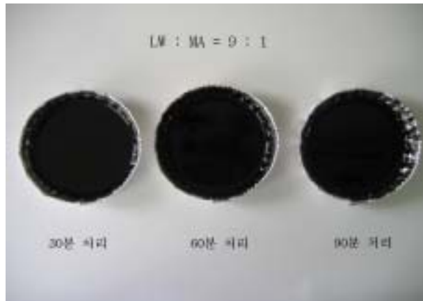
<그림 2-8> O 3 처리한 LW:MA의 각 비율로 반응 시킨 고형화 액화물
