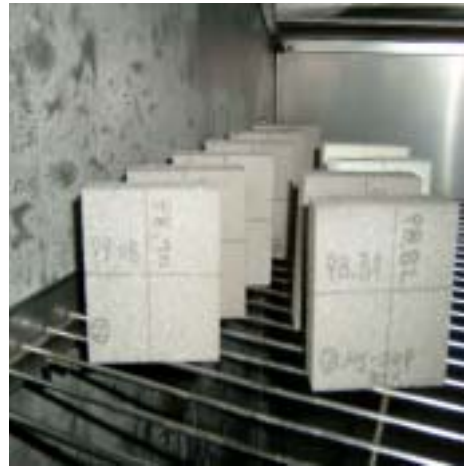
<그림 1-12> 샌드위치 패널용 액화목재우레탄 발포재의 치수안정성
