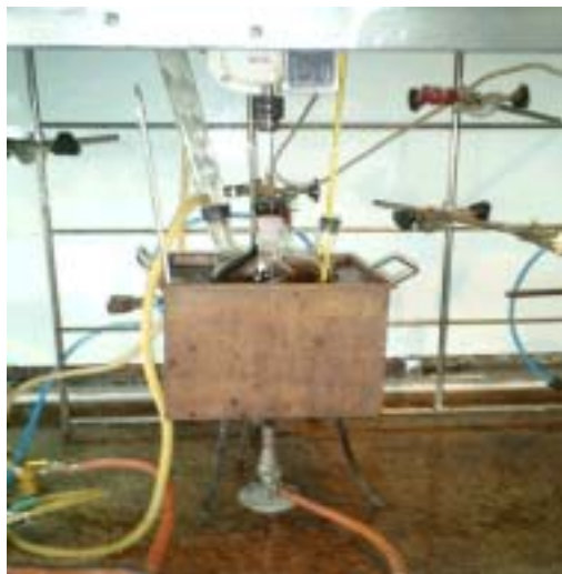
<그림 1-27> 액화목재를 이용한 레졸수지 제조
