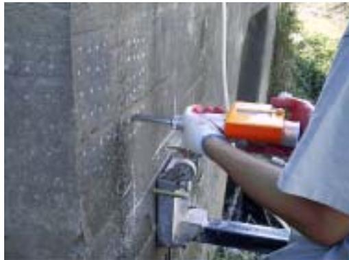
**<그림 2-9> 터널 유입부 날개벽 비파괴 강도 측정 광경**
