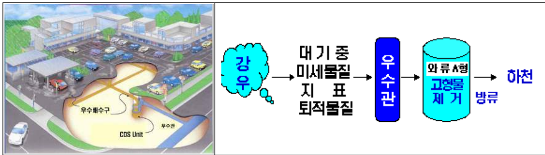
(그림 7-13) Downstream Defender의 강우처리 개념도
