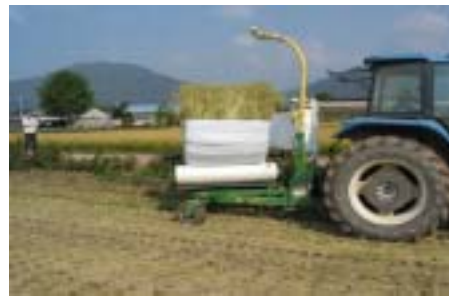
사진 14. 랩핑기로 랩핑하는 모습
