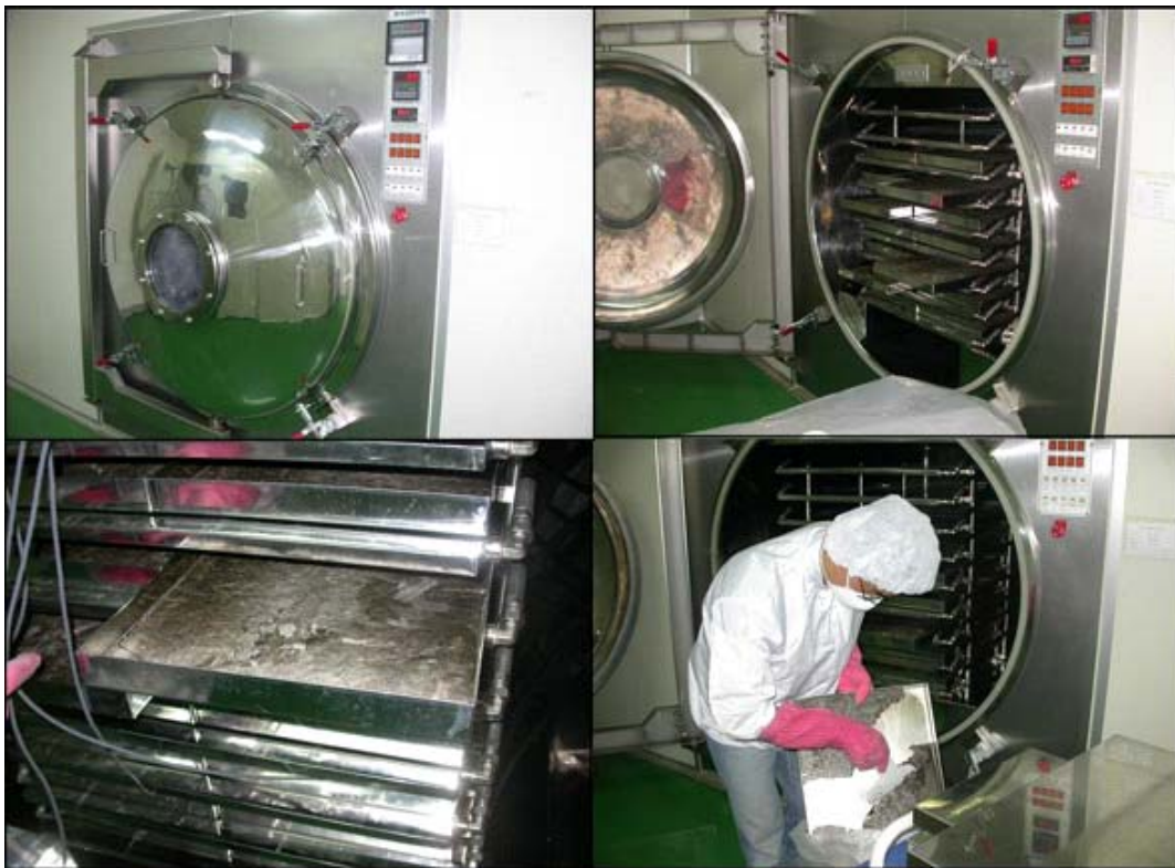
Fig. 17. 산업용 동결건조기를 이용한 흰점박이꽃무지 수용성 추출물의 동결건조.
