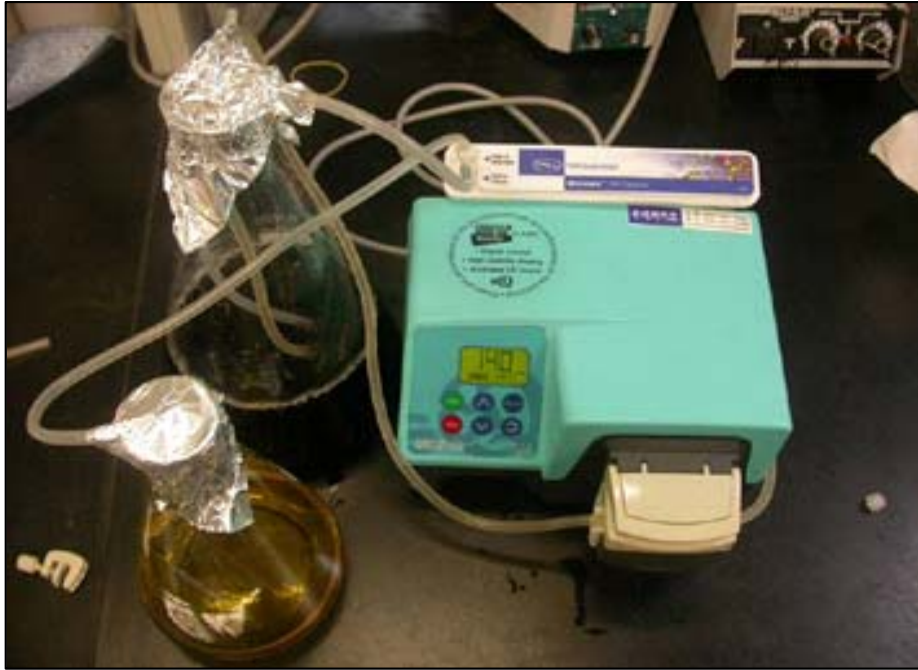
Fig. 12. Minimate TFT capsule을 이용한 ultra-filtration.
