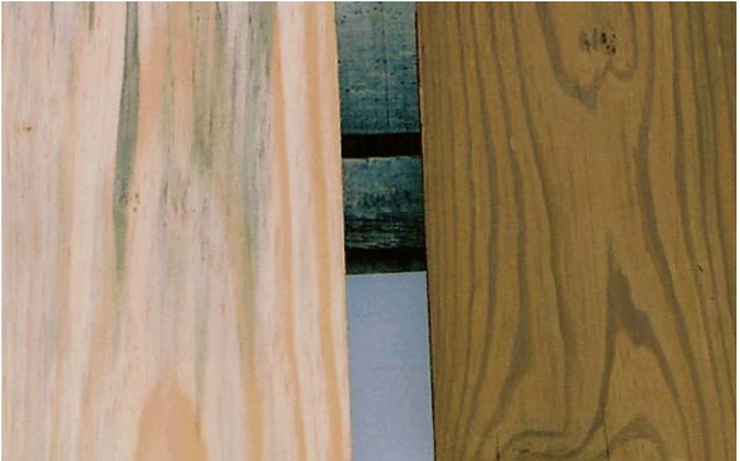
그림 115. 리기다 소나무의 열처리 전후 채색 비교. 표면 오염이 열처리에 의해 사라짐
