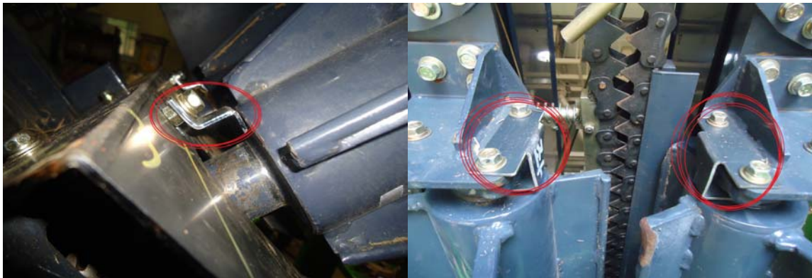
그림 50 줄기 끼임 방지 장치(좌: 탈협부 앞쪽, 우: 탈협부 뒤쪽)
