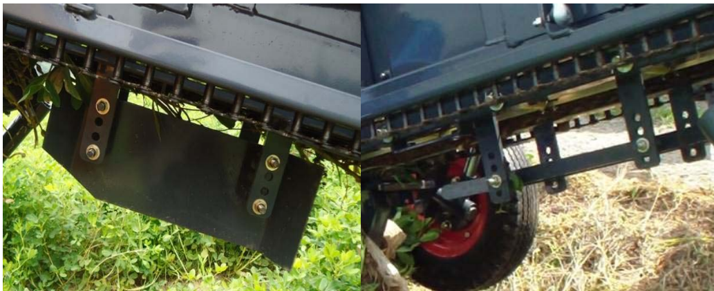
그림 46 흙털이판 형상( 좌: 땅콩 타격식, 우: 줄기 타격식 )
