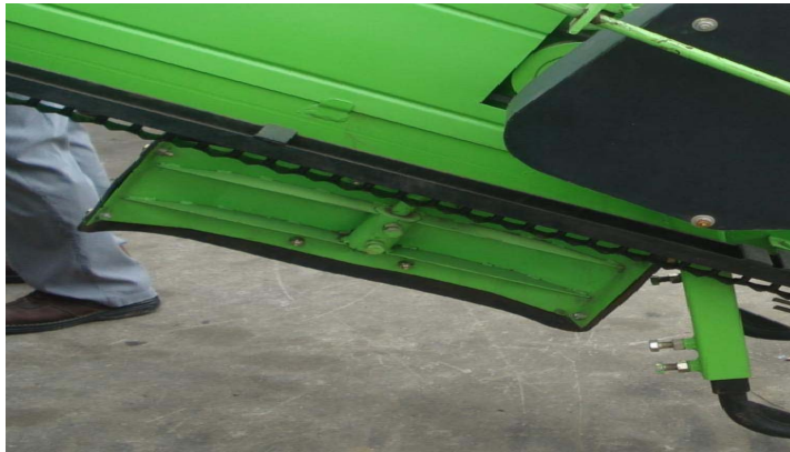
그림 10 중국 땅콩수확기 흙털이 장치
