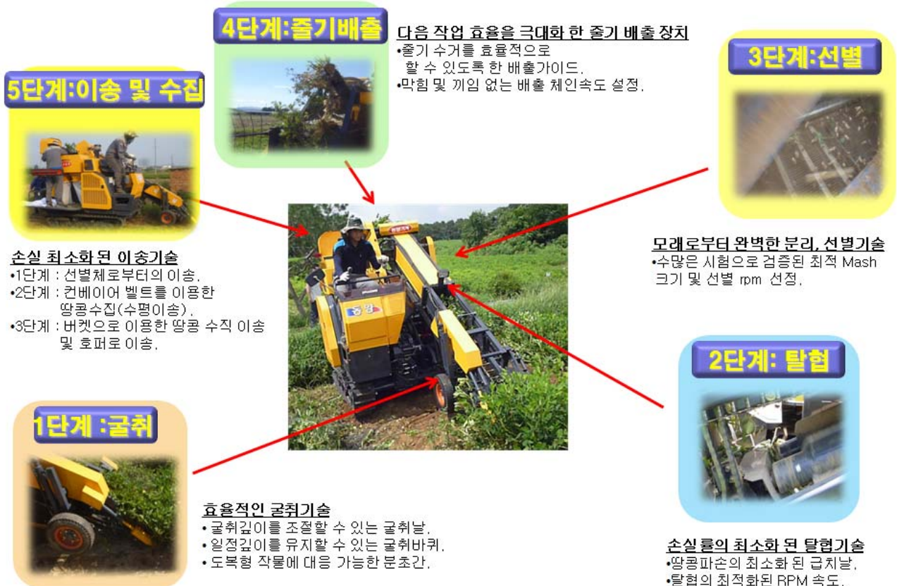
그림 5 땅콩수확기의 작동 원리 및 주요 기술
