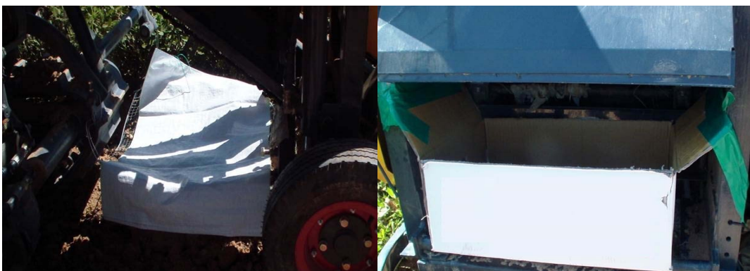
그림 47 결과물 수집장치(좌: 흙 수거상자, 우 줄기 배출구 수거상자)
