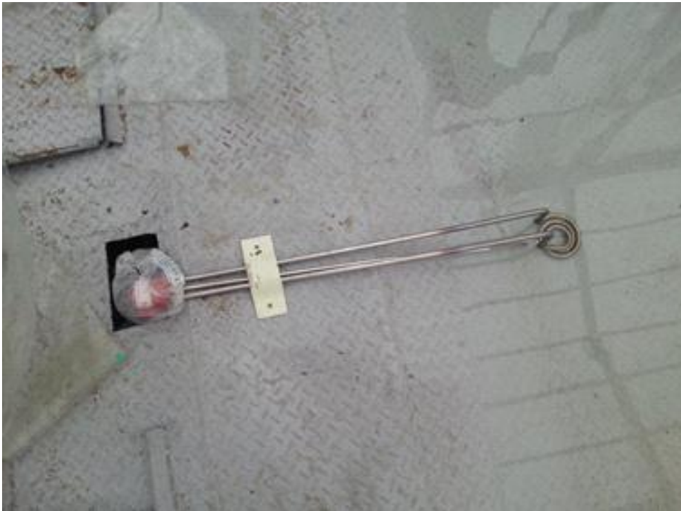
그림 1. 침수조 내에 설치된 히터의 모습.
