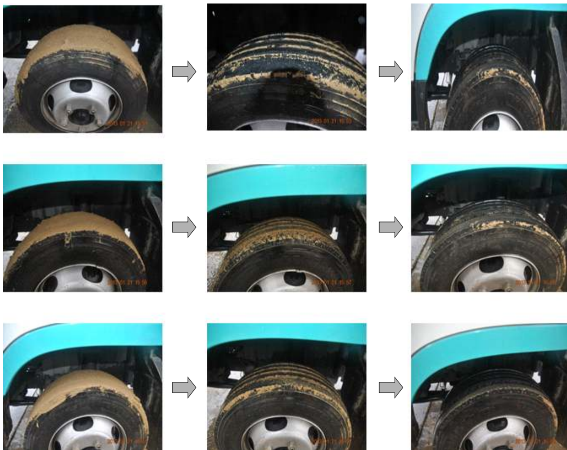
그림 7. 침수조에 의하여 차량 타이어 바퀴의 이물질이 제거된 모습.
