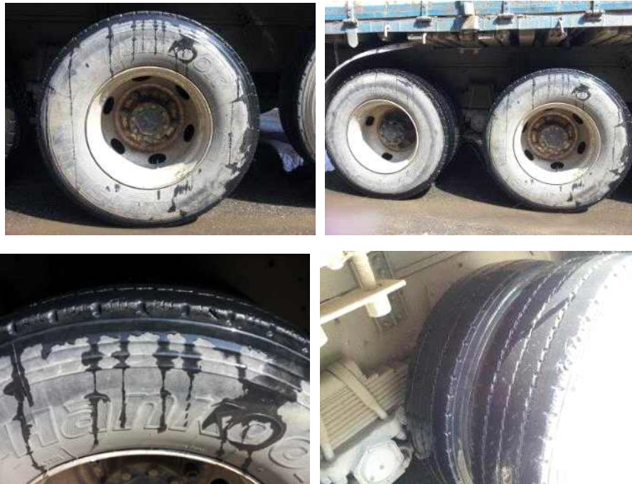
그림 3. 침수조에 의한 차량바퀴의 침수 모습.
