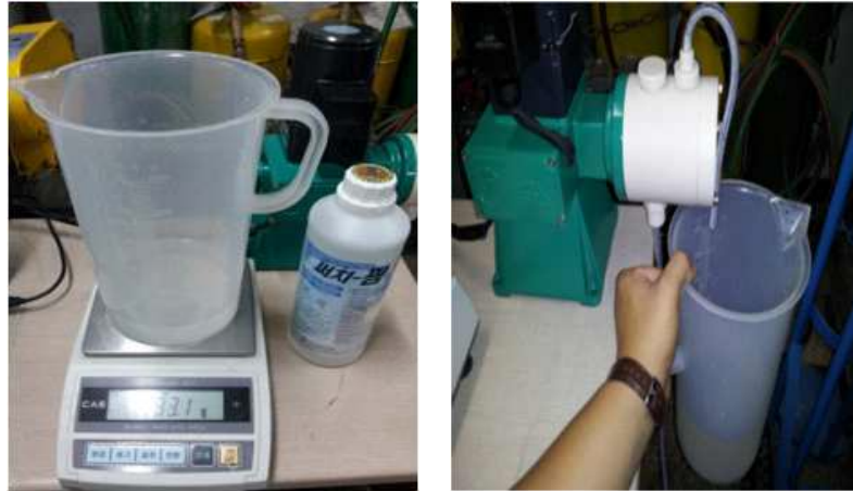
그림 18. 정량펌프 배출량의 측정 모습.
