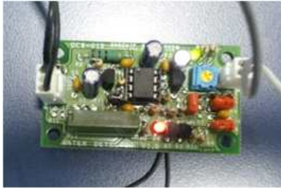
그림 7. 물 감지센서(수위센서)의 모습.
