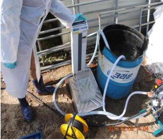
그림 4. 분무된 소독약액의 양 측정 모습.
