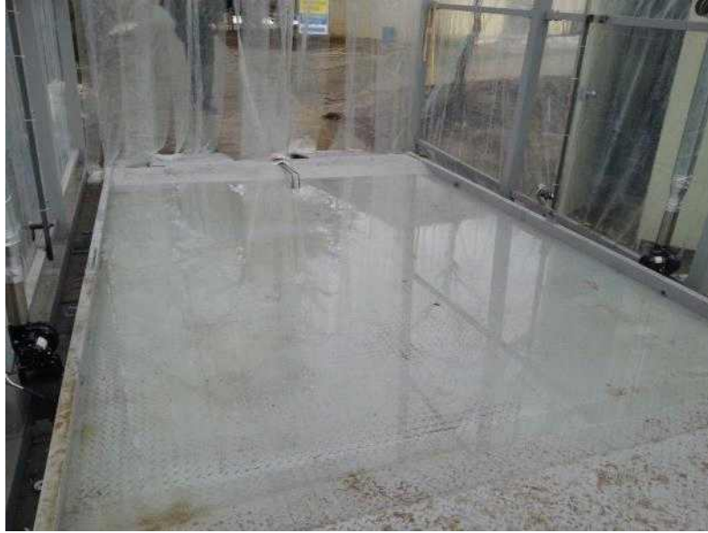
그림 4. 침수조 시제품의 설치모습.
