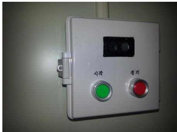
그림 9. 대인대물소독장치의 대인소독내조 내에 설치된 소독제어버튼.
