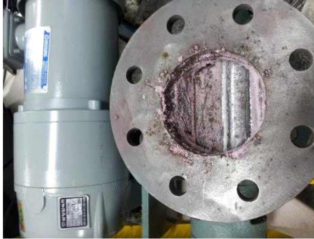
그림 22. 로타리밸브가 적절하게 작동한 모습.
