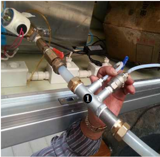
가) 한 개의 벤츄리인젝터가 연결됨 나) 두 개의 벤츄리인젝터가 직렬로 연결됨 그림 2. 오존수의 용해도를 향상시키기 위한 벤츄리인젝터.
