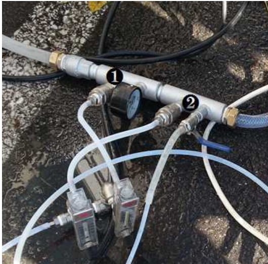
가) 한 개의 벤츄리인젝터가 연결됨 나) 두 개의 벤츄리인젝터가 직렬로 연결됨 그림 2. 오존수의 용해도를 향상시키기 위한 벤츄리인젝터.
