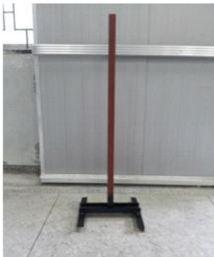
Fig. 9. 수위센서 부착 위치를 위한 받침대.
