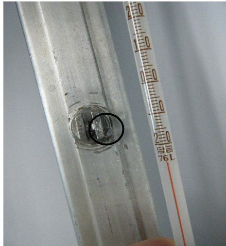
그림 1. -25 °C 하에서 얼지 않은 노즐의 모습.
