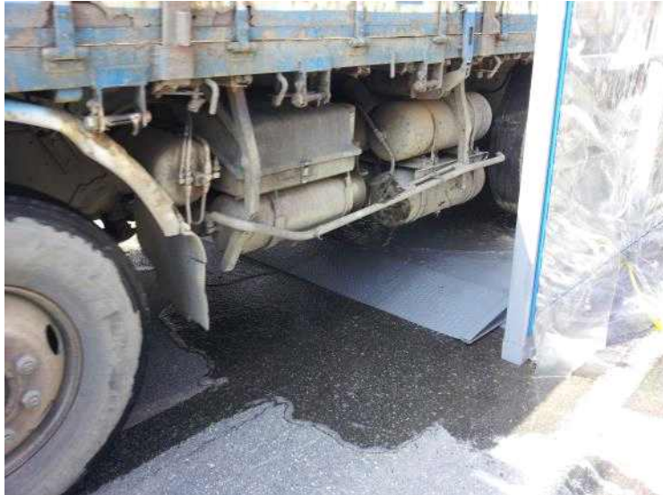
그림 4. 트럭 통과에 의한 침수조 내 소독약액의 넘침 현상.
