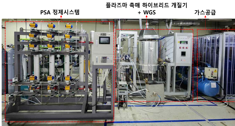
[그림 86] PSA 정제시스템 연계 구축 모습
