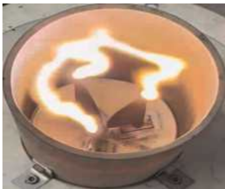
(a) 저유량에서의 아크길이가 최대일 때 방전 모습
