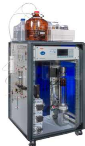
[그림 129] 액체크로마토그래피-유기탄소 검출기와 원수의 LC-OCD 분석 결과
