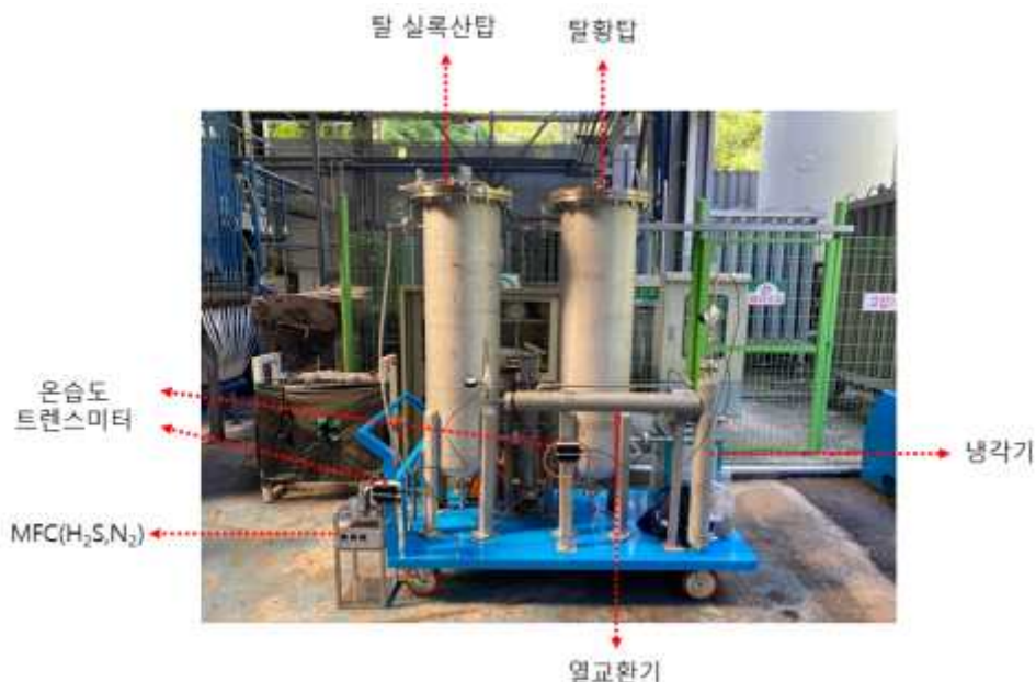
[그림 9] 150 Nm 3 -H 2 /일급 바이오가스 정제설비 구축 모습
