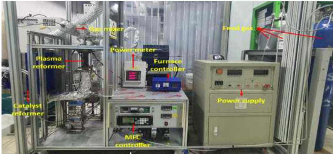
[그림 28] 랩스케일 플라즈마-촉매 개질시스템 구축 모습
