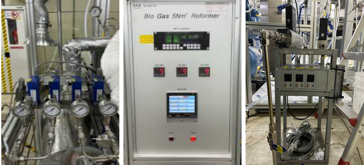
(a) 개질시스템 MFC (b) 개질시스템 Controller (c) WGS Air Controller
