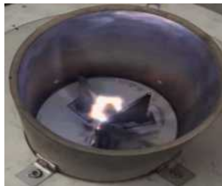
(b) 타겟 유량에서의 아크길이가 최대일 때 방전 모습
