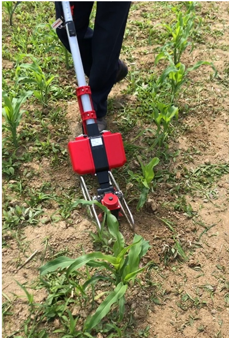
그림 28. 경량 전동 호미 포장 시험(옥수수 포장)
