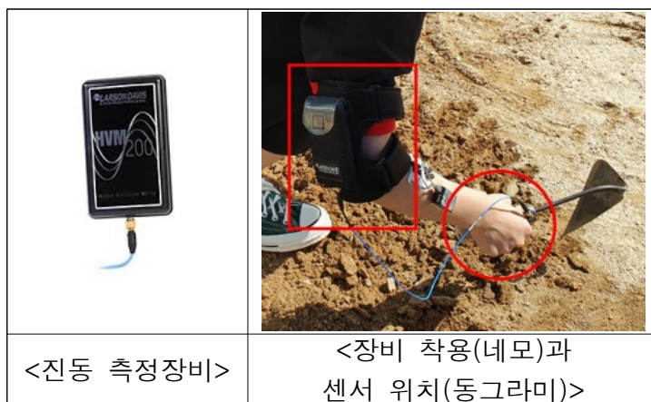
그림 47. 국소진동 측정 및 수준 평가 시험
