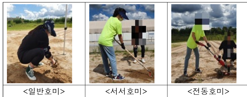
그림 43. 호미 종류에 따른 작업자세 평가 시험
