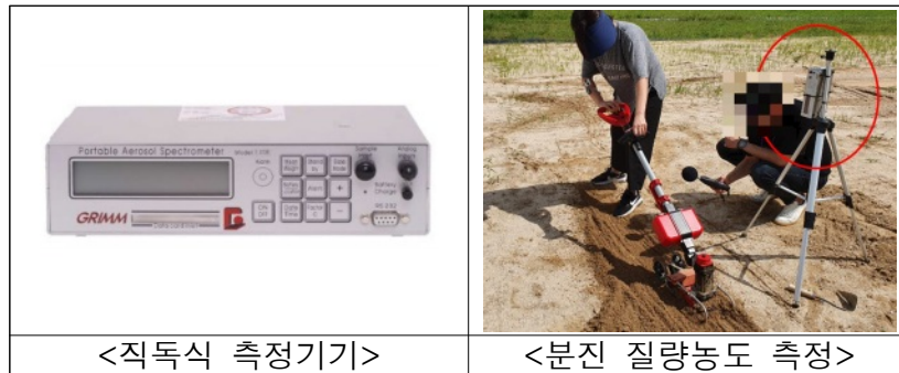
그림 48. 분진 발생 측정 및 수준 평가 시험
