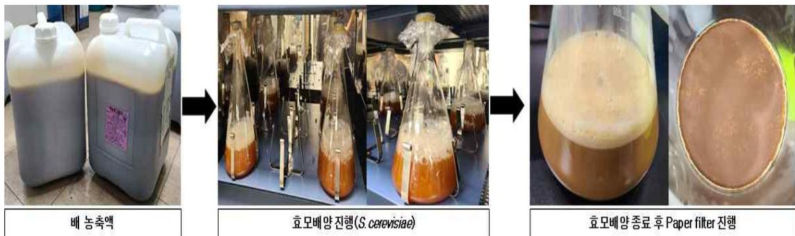
그림 17. 배 농축액을 이용한 효모발효 진행 과정(Lab scale)
