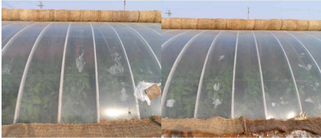
<그림> Test 2. 제품 열화현상
