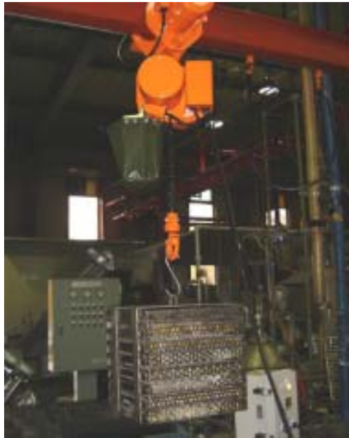
그림 4-11. 박피밤시료 적재함 조합 이송 호이스트 시작품 모습
