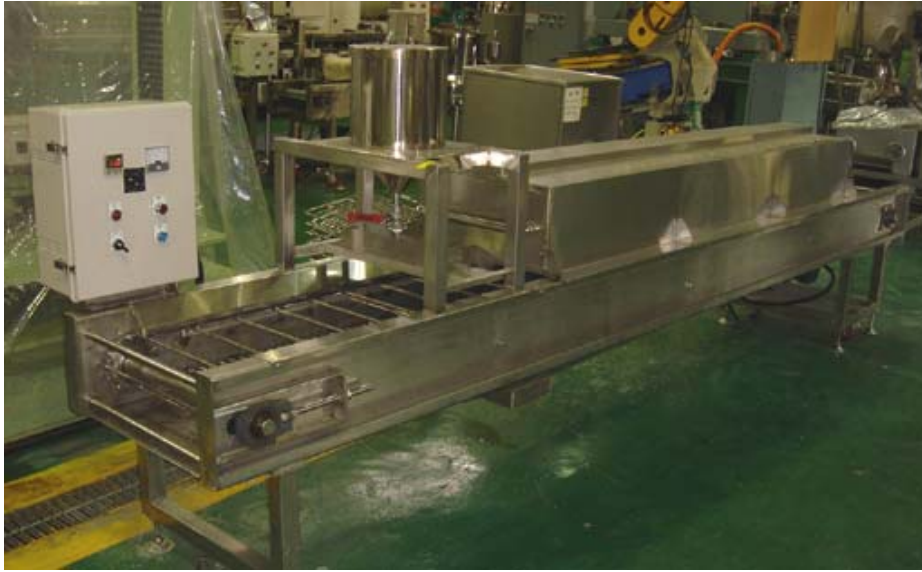
그림 4-15. 당절임밤 당입힘(glazing) 시스템 시작품
