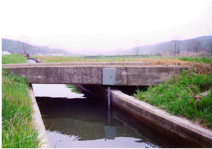
<그림 3-3> 사각형 수로의 수위 측정 장치 설치 및 운영(농림부 2003)
