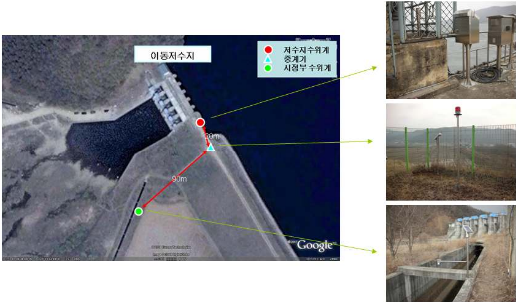
<그림 3-100> 이동저수지 취수탑 및 수위계측기
