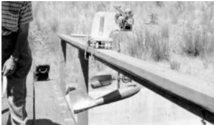
Figure A4-6-7 교각 위에서 유속계미 무게추를 운행하기 위한 이동 및 추적시스템
