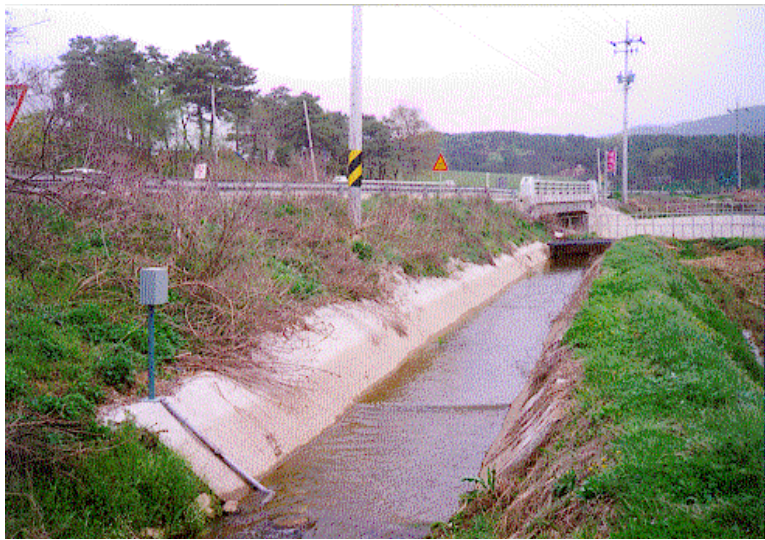
<그림 3-4> 사다리꼴 수로의 수위 측정 장치의 설치 및 운영 (농림부 2003)
