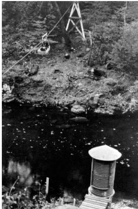
Figure A4-6-3 케이블카를 이용한 수위측정, 주름진 수위관측지점 및 정수지
