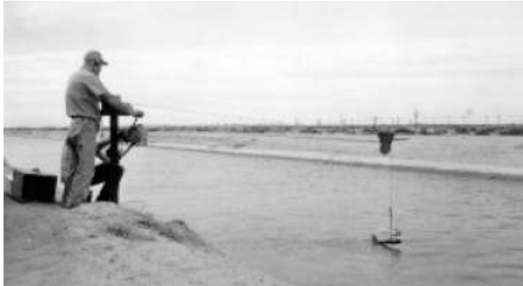
Figure A4-6-6 유속 및 위치를 읽을 수 있도록 고안된 이동블럭 및 케이블
