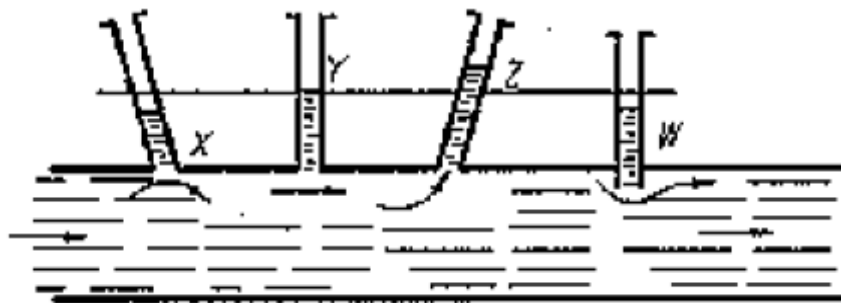
Figure A4-4-7 피조메타 설치 방법에 따른 수두
