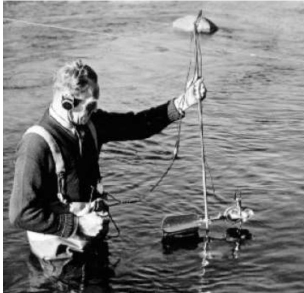
Figure A4-6-2 도섭측정을 위한 장치, 측정지점 표식라인을 주목
