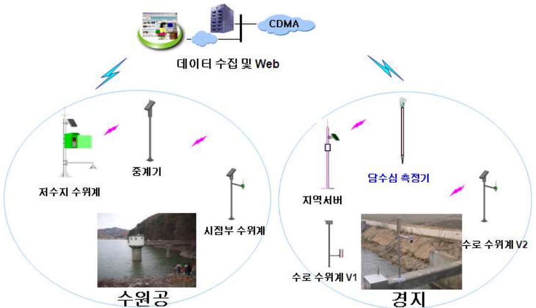
<그림 3-65> 자동수위계 및 수로수위계 네트워크 구성
