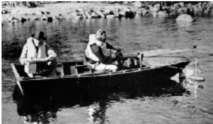
Figure A4-6-5 보트에서 유속을 측정하는 장면
