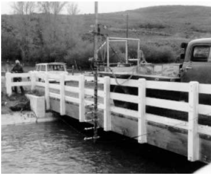
Figure A4-6-14 트럭에 설비된 8개 프로펠러 유속계의 모습 및 신호기록장치 (Gateway Canal, Weber Basin Project, Utah)
