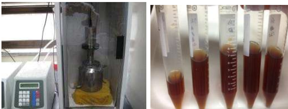
그림 70. Ultrasonic apparatus and sonicated samples(Ganjang)
