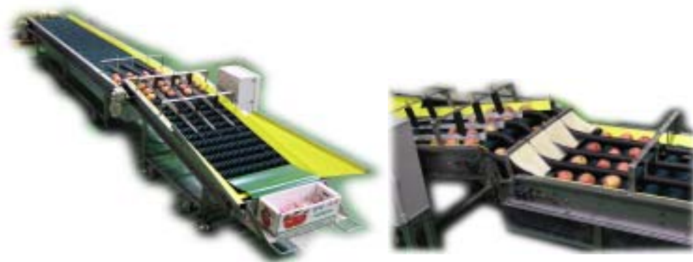
그림 2. 과일 자동공급 정렬 시험장치
