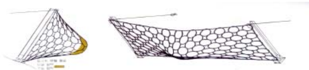
(그림 3) 유연성 방호책의 작동 메카니즘 (II)
