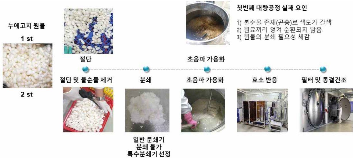
<그림> 실크 펩타이드의 대량 생산을 위한 공정 시험 개요
