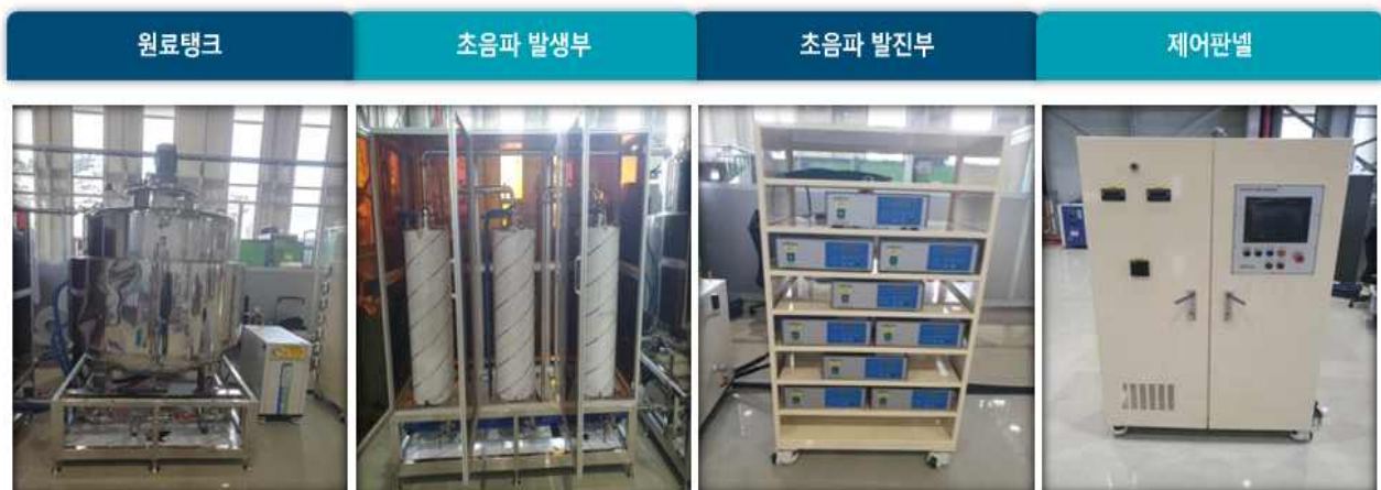
<그림> 한국식품연구원 보유 대량생산용 순환형 초음파 장치
