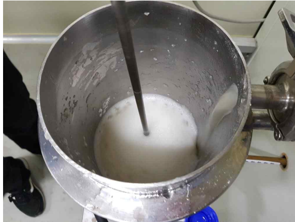
<그림> 순환형 초음파 장치를 이용한 실크 단백질의 가용화 과정
