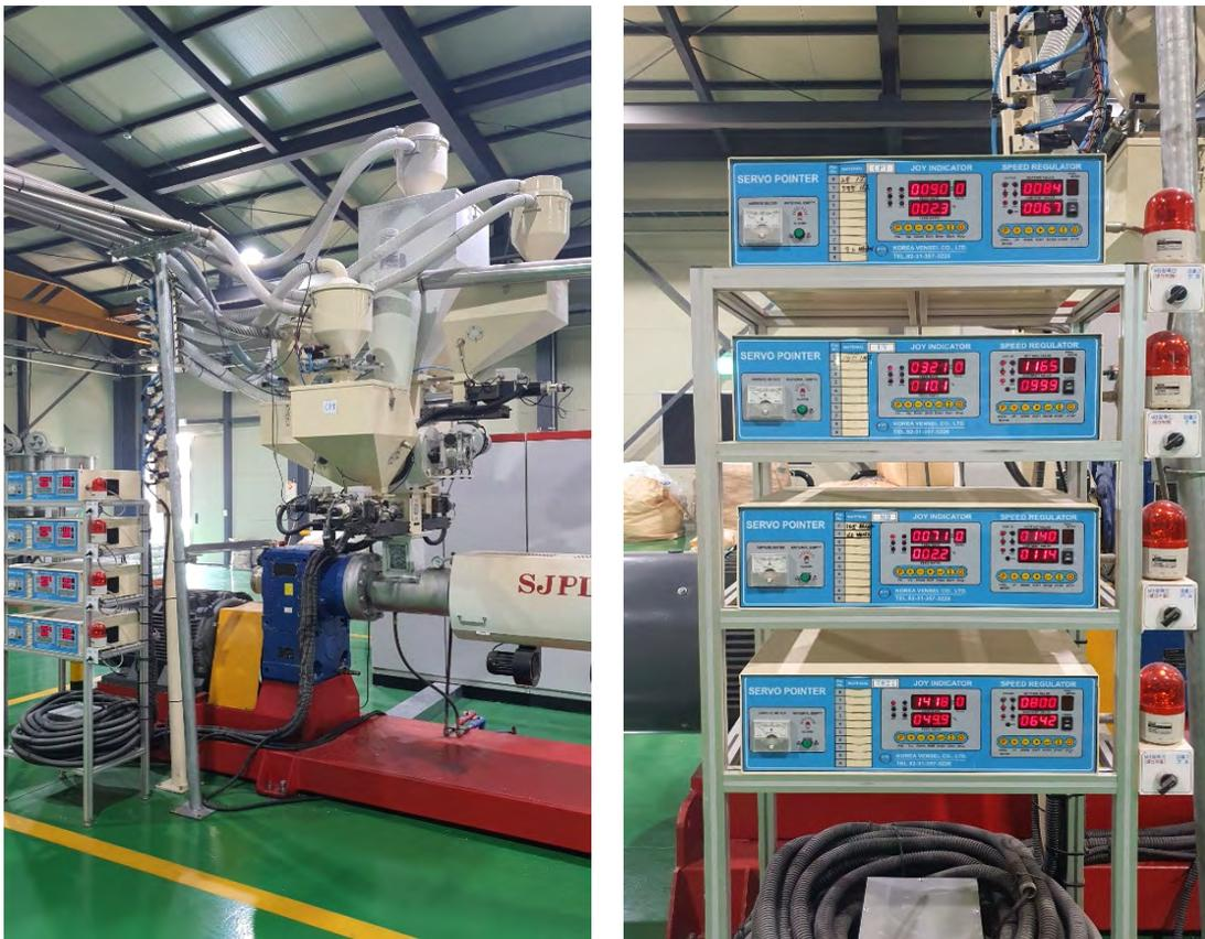
Fig. 기능성 Master batch 혼합 시, 원료 투입 호퍼 구성 및 온도 조절
