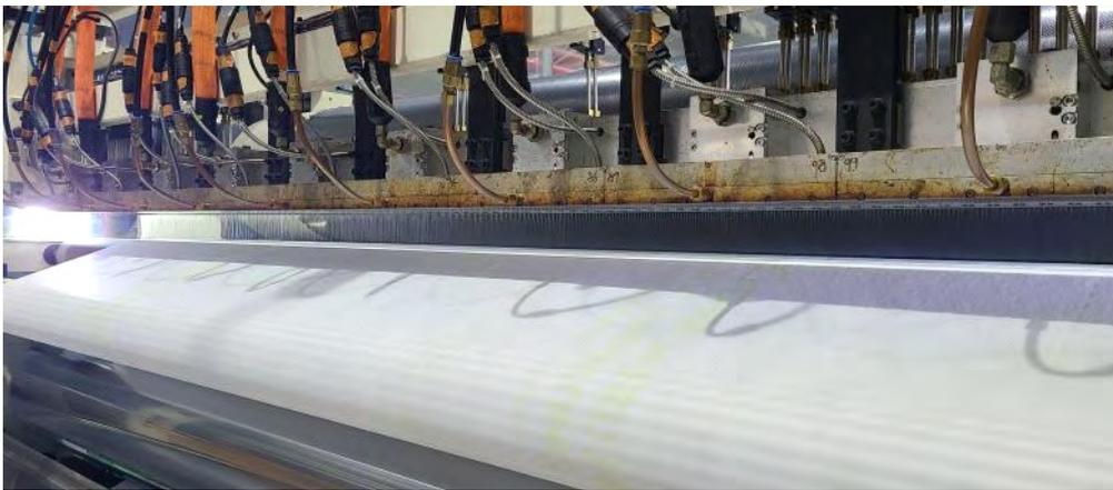
Fig. Nonwoven fabric(White) 공급 및 상단부 노즐에 의한 접착 재료 분사
