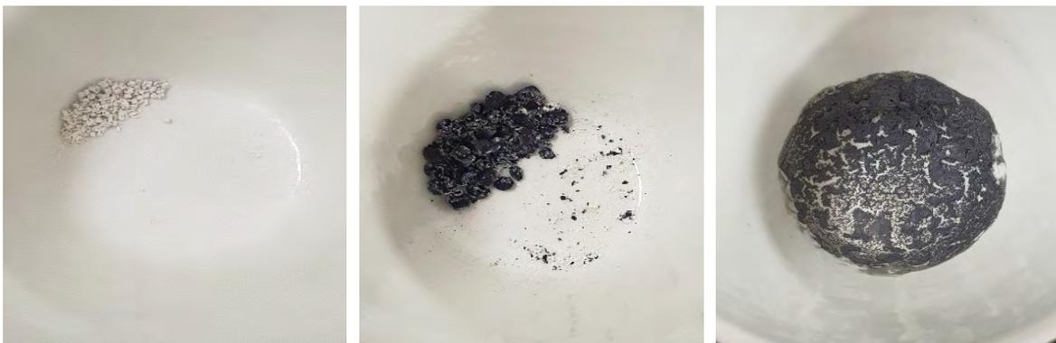
Fig. 기존 Black Master batch와 1차년도 개발 광발열 Master batch의 분해 후, 잔여물 (왼쪽부터 기존 PE, 기존 PP, 개발 광발열 PE 소재)
