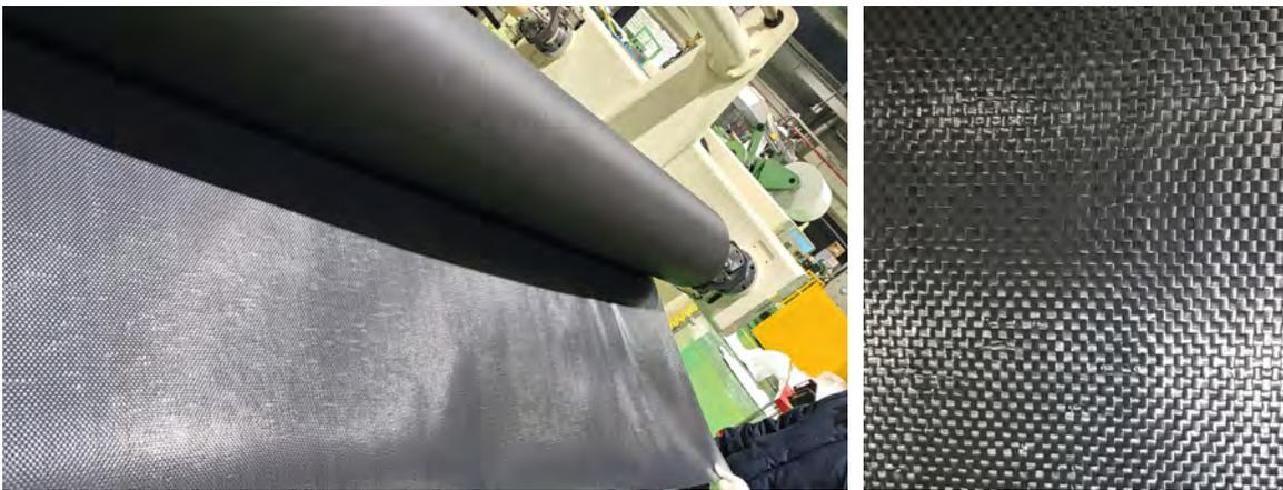
Fig. 광발열 원단 + Nonwoven fabric(Black) + Breathable film 합포 원단
