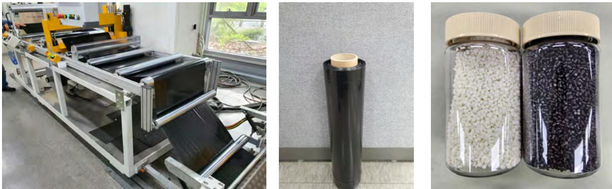
Fig. 필름 방사 공정을 통해 제조된 광발열 기능성 필름과 이를 제조하기 위해 적용된 M/B
