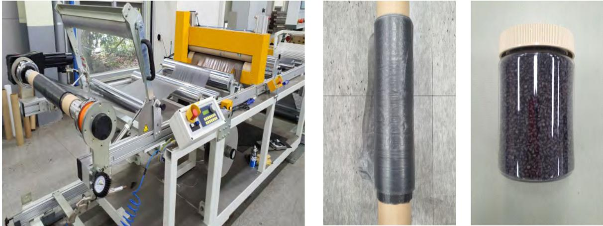
Fig. 필름 방사 공정을 통해 제조된 광발열 필름과 이를 제조하기 위해 적용된 광발열 M/B
