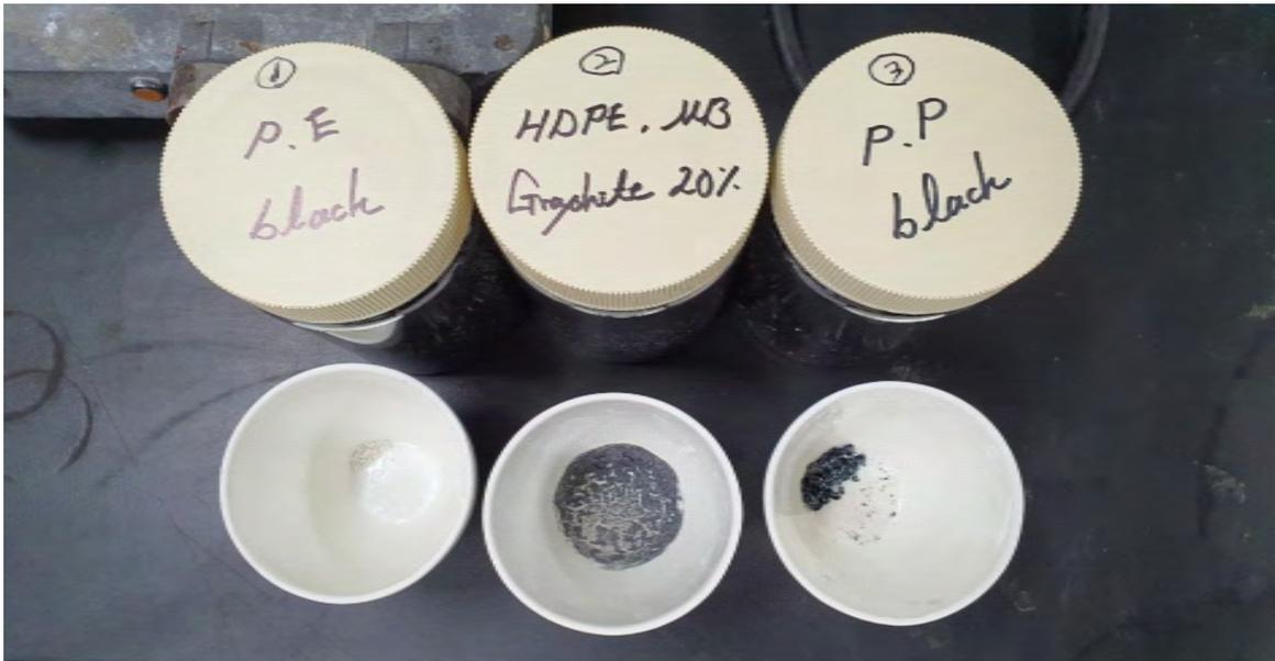
Fig. 기존 Black Master batch와 1차년도 개발 광발열 Master batch Chip
