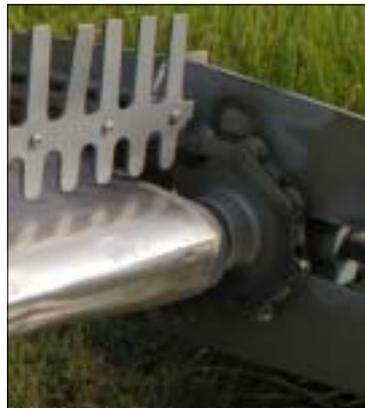
사진 3.5.8 구동용 스프로킷과 설치 모습
