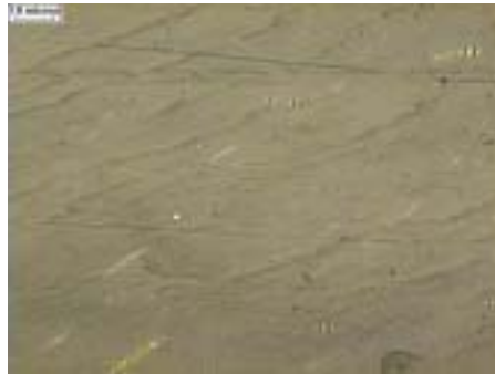
그림 25. MgO/EVA 마스터 배치 단면 광학현미경 사진
