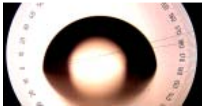
그림 17. 폴리에틸렌의 접촉각 그림 18. 5 wt% 무수말레산이 grafting된 PE 접촉각
