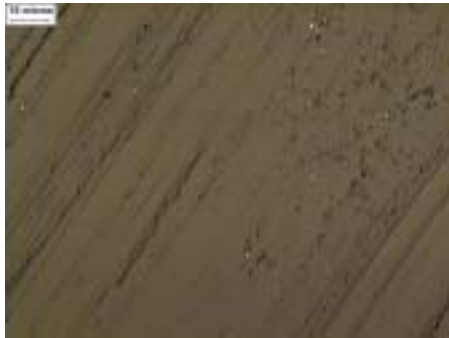
그림 24. EVA sheet 단면 광학현미경 사진
