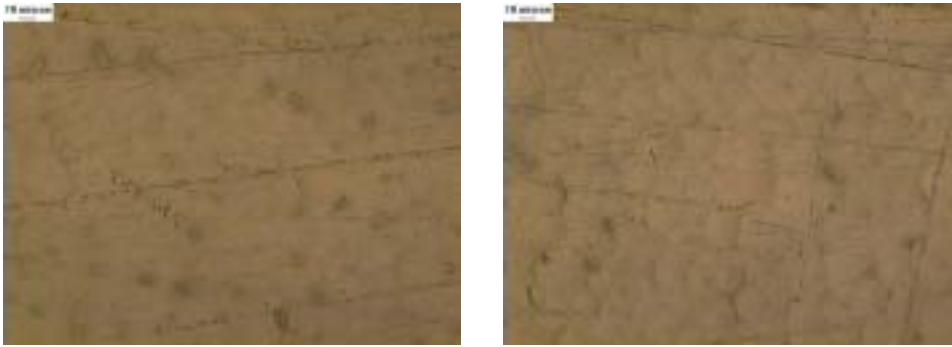
그림 22. PE 필름 표면(좌)과 24 시간 UV 조사 후 PE film 표면(우)
