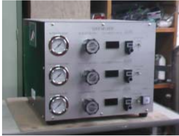
그림 4. MFC를 이용한 실험용 1차 혼합가스 system 기기
