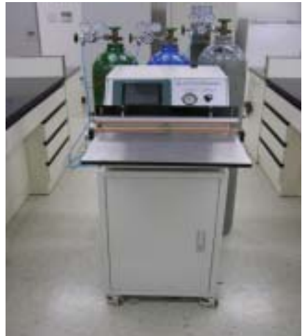
그림 12. MFC를 이용한 실험용 2차 혼합가스 system 기기
