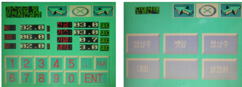
그림 7. 혼합가스 제어시스템(좌: 연구용, 우: 보급용)
