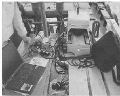
[사진 5] GPS 이동국(측량선에 설치) 음향측심기 설치
