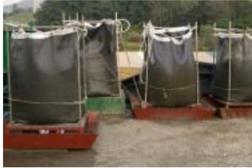
[사진 48] Geo bag(지지대,배수받침대 설치)
