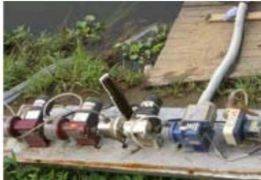
[사진 58] 유입수정량펌프(시작품) 설치
