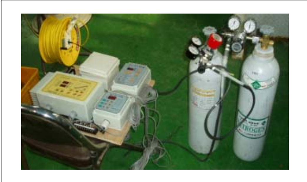
[그림3-43] 1차 년도에 사용한 암모니아 센서의 표준가스로 검정장면
