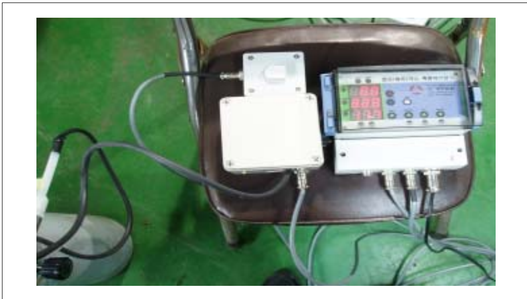
[그림3-44] 2차 년도에 사용한 암모니아센서의 표준가스에 의한 검정장면
