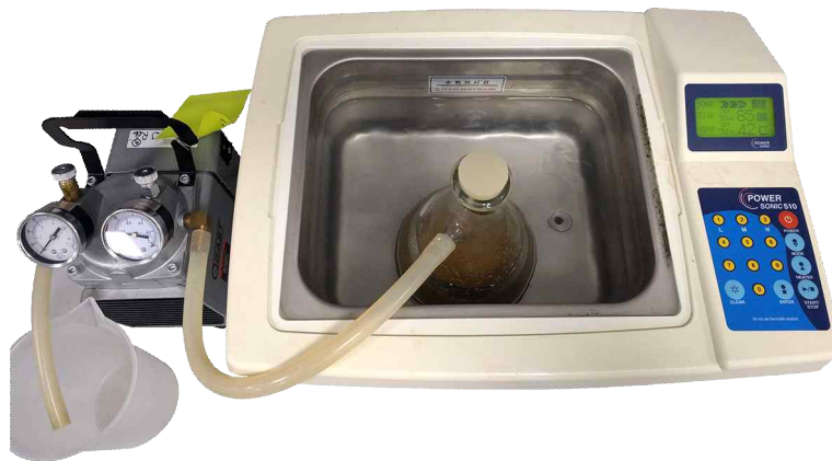
그림 6. 쏘니케이션과 고온을 이용한 천연육수용액 탈기 과정
